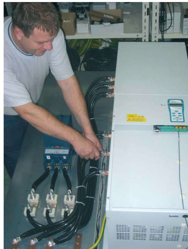
Obr.4 VQFREM 400 V – 250 kW pre podnikové vodné hospodárstvo
