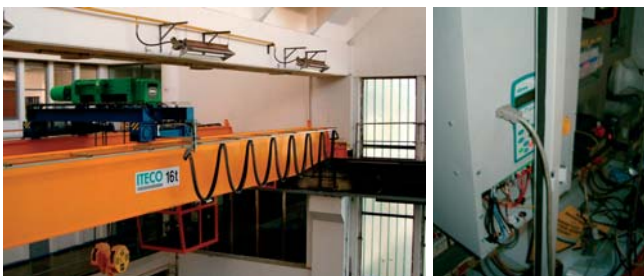
Obr.3 Regulácia pojazdu nového 16 t žeriava pomocou FM VQFREM 400 110 (400 V, 110 kW)
