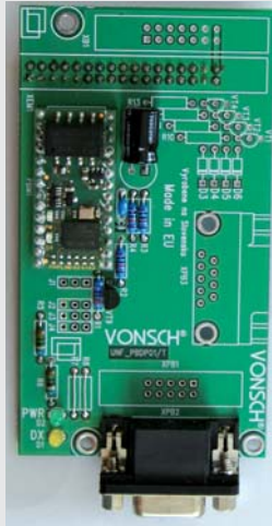
Rozširovací modul Profibus_UNI pre pripojenie s frekvenčným meničom UNIFREM 400
