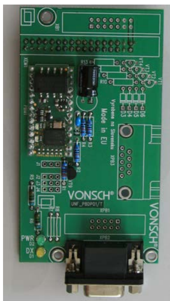
Rozšiřovací modul Profibus_UNI pre pripojenie s frekvenčným meničom UNIFREM 400
